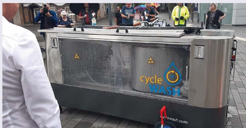
Die „Cycle Wash Duo“, ein Produkt der CW Cleaning Solutions GmbH, Köln, verfügt über einen Normal- sowie einen Eco-Modus und verbraucht entweder 4-8 oder nur 0,5 Liter pro Waschgang. Mit nur 65 dB Geräusch-Emission ist die Maschine dabei „flüsterleise“, wie der Hersteller auf seiner Website www.cyclewash.com verspricht.
