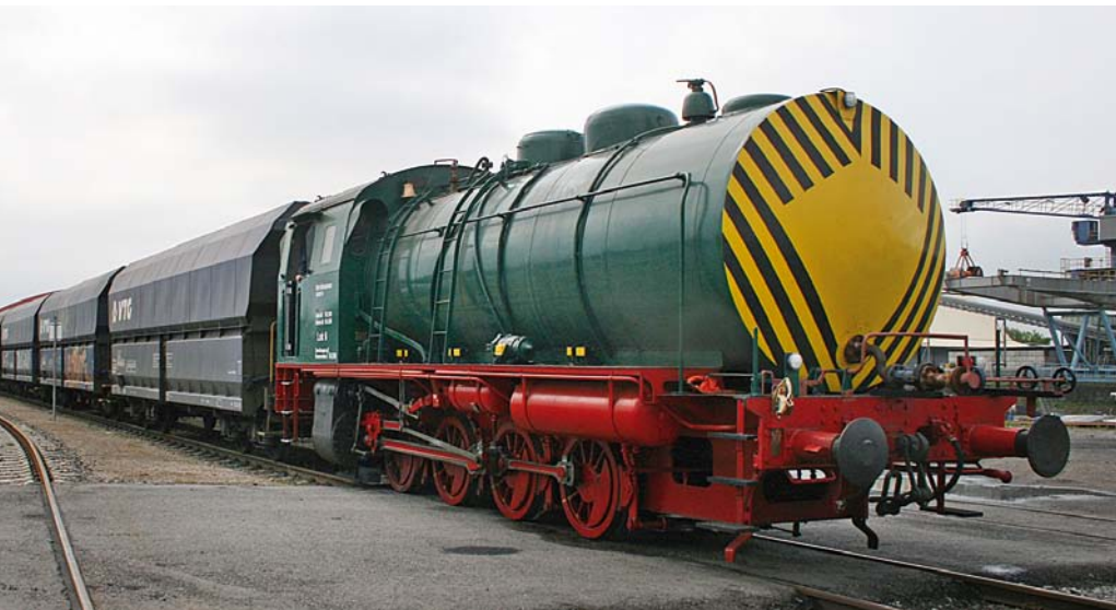
Leistet im GKM Mannheim gute Dienste – die 64 Jahre alte Gelsenkirchener Dampfspeicherlok
